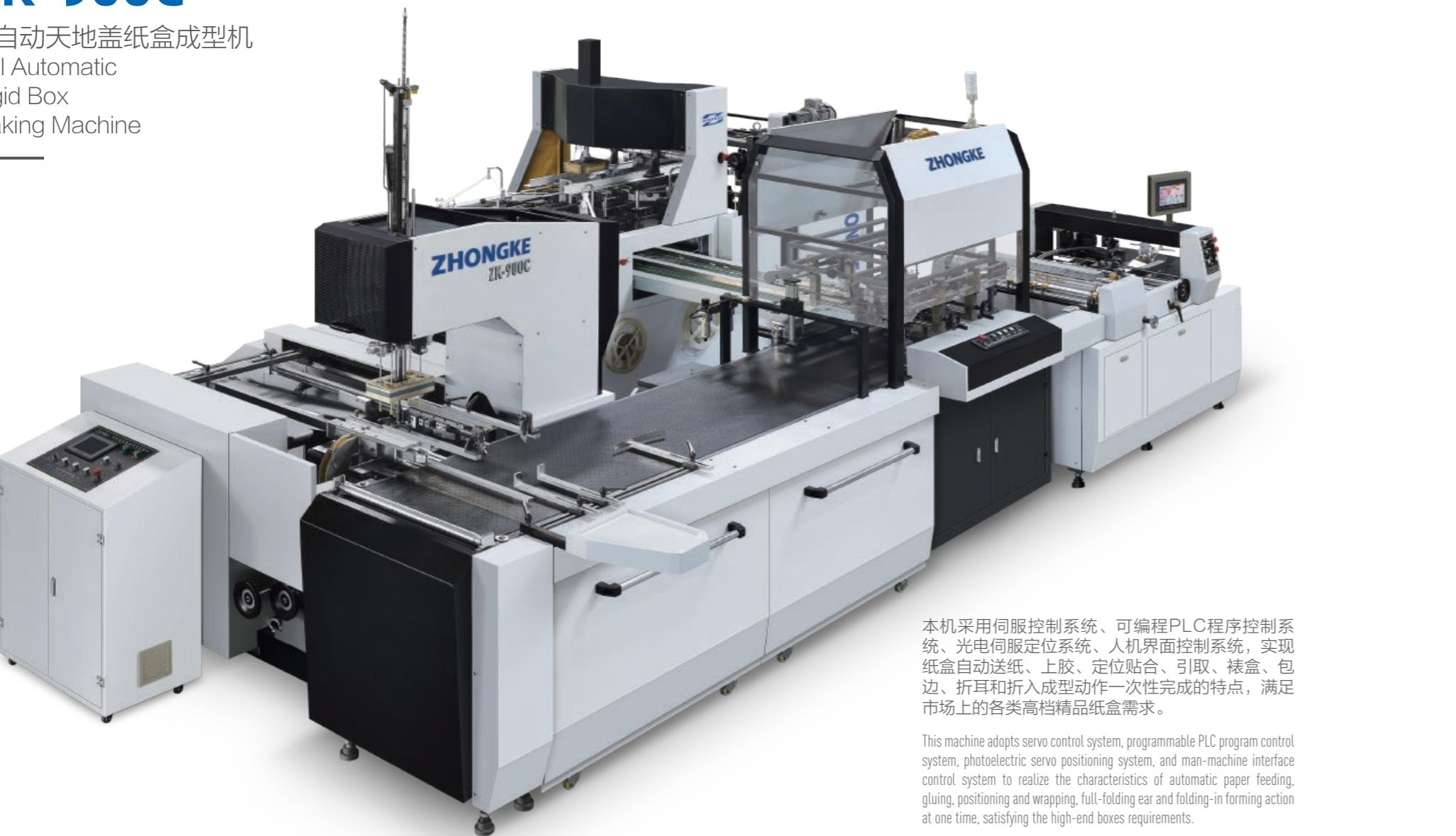
本机采用伺服控制系统、可编程PLC程序控制系统、光电伺服定位系统、人机界面控制系统，实现纸盒自动送纸、上胶、定位贴合、引取、裱盒、包边、折耳和折入成型动作一次性完成的特点，满足市场上的各类高档精品纸盒需求。
